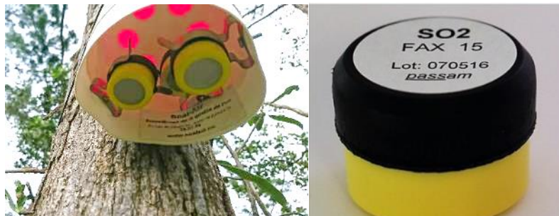
Figure 1: Dispositif de mesures passives du SO_2 par tubes Passam Ag
